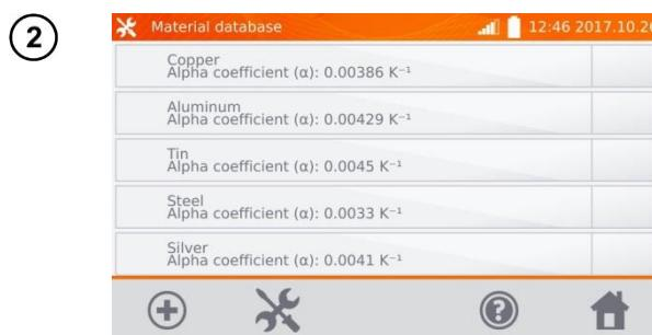
O instrumento inclui 5 materiais gravados na memória com seus coeficientes: cobre, alumínio, estanho, aço e prata. Usar para adicionar um novo material.
