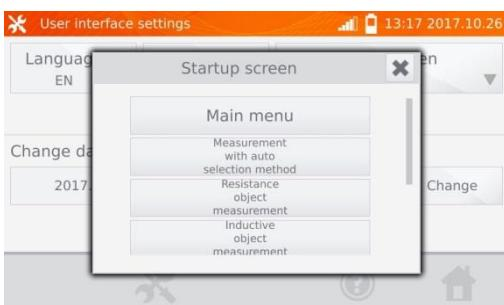
Selecionar a tela inicial que será apresentada quando o instrumento for ligado. Esta função é útil quando se realiza medições de um dado tipo durante longo tempo.
