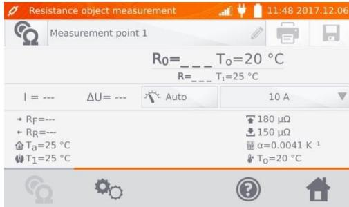
8 Conectar o instrumento no corpo de prova. Em seguida, acionar **START/STOP**.
