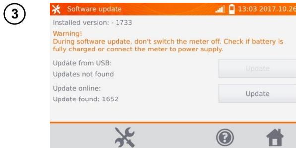
O instrumento não deve ser desligado na operação.
